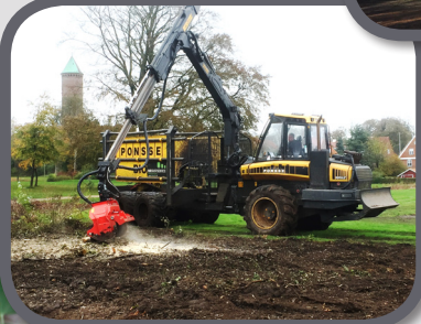
Knusning langs veje – her ekvipage under opbygning med skiltelys til nye opgaver ved motorvejsaf-/tilkørsler.
