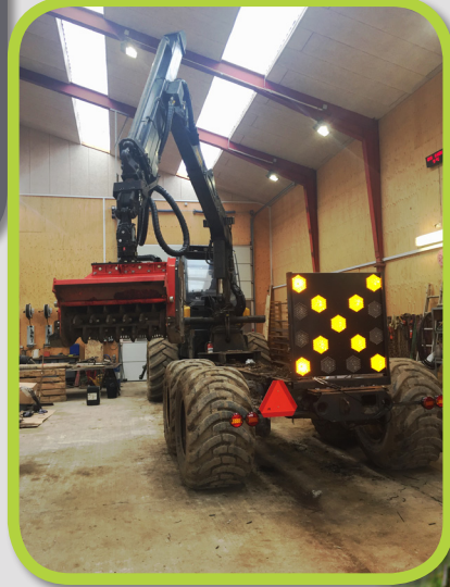
Knusning langs veje – her ekvipage under opbygning med skiltelys til nye opgaver ved motorvejsaf-/tilkørsler.
